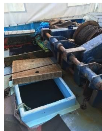
Figure 6 : Photo de la cuve en circuit ouvert servant de vivier par immersion sans refroidissement de l'eau
