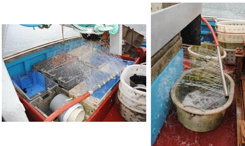
Figure 9 : Photos de dispositifs permettant l'aspersion des langoustines pendant la phase d'attente avant la mise en vivier
