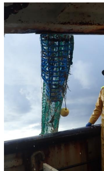
Figure 4 : photo de la grille à lottes lors des essais en mer
