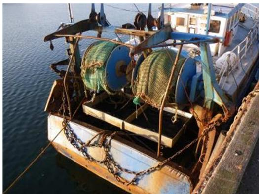
Figure 5: Vue de l'ensemble du pont arrière avec la table de tri sous les enrouleurs.
