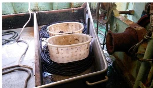
Figure 8 : Bac de tri amovible en position avancée
