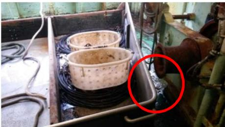
Figure 15 : Bac de tri en position avancée illustrant la difficulté d'accès aux dalots dans cette situation (cercle rouge).
