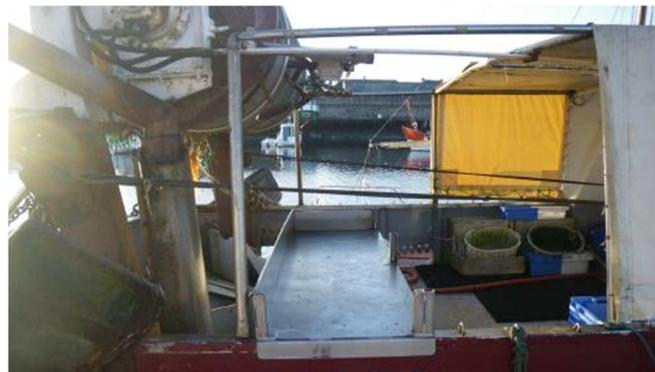
Figure 13 : Table de tri déportée posée sur la lisse.
