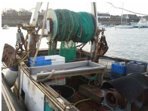
Figure 6: Vue du pont arrière d'une table de tri déportée posée sur la lisse.
