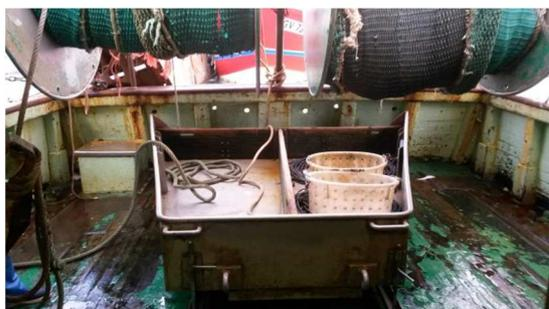
Figure 7 : Bac de tri amovible en position arrière
